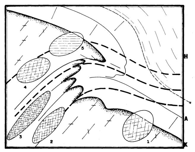
Abb. 13 Verformungsschema des aarmassivischen Nordrandes. - Die Verformungsellipsen geben Verformungsbeträge und -modi für spröd verformtes (1), spröd-duktil verformtes (2, 3) und spröd und rotationell verformtes Grundgebirge an (4, 5). Die durchbrochenen Linien verbinden die aarmassivische Schieferung mit der regionalen Schieferung des Helvetikums. - H: helvetischer Dogger, A: autochthone Sedimente, K: kristallines Grundgebirge.
