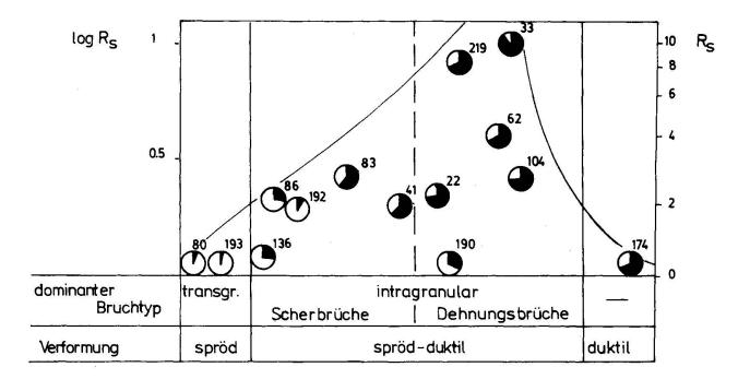
Abb. 11 Klassifikation der Mikrostrukturen. R<sub>s</sub> Achsenverhältnis von Verformungsmarken in XZ-Schnitten. Die schwarzen Kreissegmente geben für jede Probe den Grundmassegehalt an.
