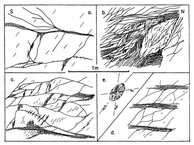
Abb. 4 Gefüge und Strukturen aus vier unterschiedlich verformten Bereichen des Innertkirchner Kristallins. Die angegebenen R<sub>s</sub>-Werte sind Achsenverhältnisse der Verformungsellipse und wurden aus der Abwicklung der Sedimente am Sediment-Kristallin-Kontakt abgeschätzt (Kammer, 1985).
