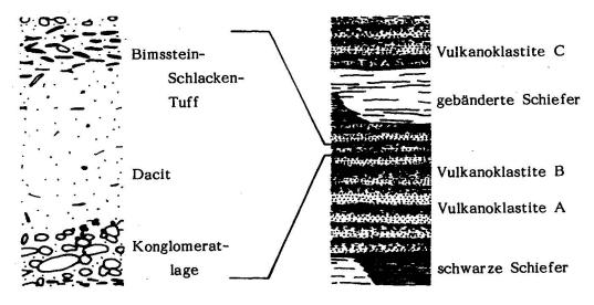
Abb. 2 Links: Darstellung einer vulkanoklastischen Abfolge (0,5-100 m mächtig); rechts: schematisches Profil durch die Gliems-Formation (Gesamtmächtigkeit rund 1 Kilometer), welche aus Metavulkanoklastiten und Metapeliten besteht.
