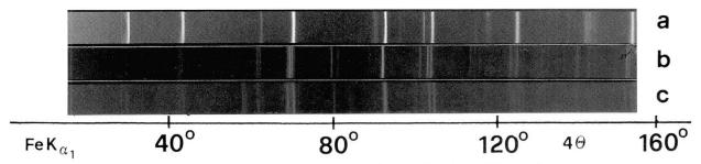
Fig. 4 Les diagrammes de diffraction aux rayons X: a) La hollandite de Kajlidongri tétragonale; b) La hollandite de Kajlidongri monoclinique; c) La hollandite de synthèse (GIOVANOLI et BALMER, 1981).
