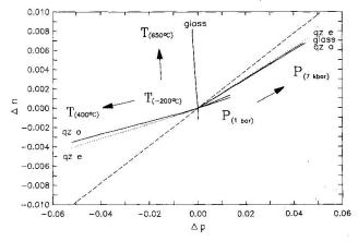
Abb. 1 Variation von Brechungsindex ( $\Delta n$ ) und Dichte ( $\Delta \varrho$ ) für SiO<sub>2</sub>-Glas und Quarz unter hydrostatischem Druck oder extremen Temperaturen. Es ist nur die Differenz zwischen gemessenen Werten (n,  $\varrho$ ) und den Referenzwerten bei Normaldruck und Raumtemperatur dargestellt.
