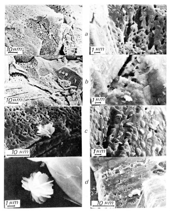
Fig. 6 Attaque des pyrites du site d'Itxassou. a) et b) Deux aspects de l'attaque en «galeries» que l'on peut rapprocher de celle de la figure 5.
