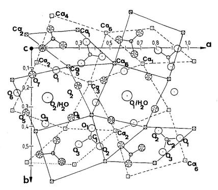
Fig. 1 Représentation schématique d'une projection sur le plan ab où les atomes représentés en blanc ont comme coordonnée Z:0.25, les atomes représentés de manière striée 0.75 (sauf les molécules  $H_2O$ ).
