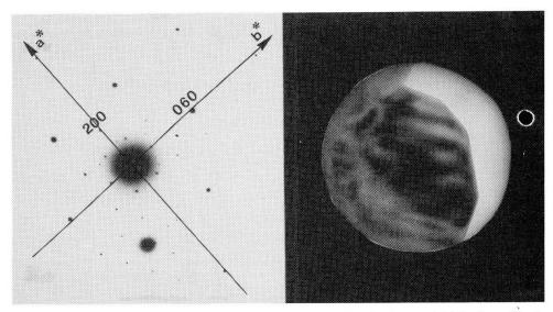
Fig. 5 Microdiffraction électronique d'une plaquette choisie de lithiophorite synthétisée. Les réflexions importantes se dérivent de la pseudo-maille hexagonale (voir fig. 3); les axes et les réflexions indexées correspondent à la vraie maille.
