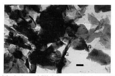
Fig. 14 Association intime des plaquettes de lithiophorite avec la goethite - G - (α-FeOOH) dans les latérites de la Nouvelle Calédonie (Microscope électronique à transmission, le tiret =  $1 \mu$ ).
