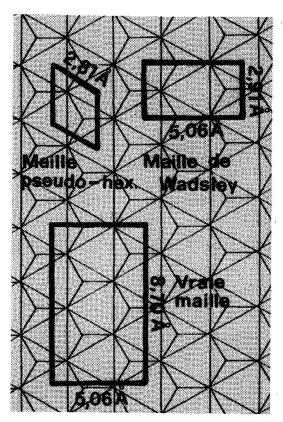
Fig. 3 Projection des trois mailles élémentaires sur le plan (001): La plus petite, qui est pseudo-hexagonale, produit les réflexions les plus intenses dans la microdiffraction électronique. Elle indique la symétrie de la couche  $[Mn_6O_{12}]^{-2}$ . La maille de Wadsley résulte des positions Li<sup>+</sup> et Al<sup>3+</sup> non ordonnées, tandis que la vraie maille correspond à l'ordre de ces sites tel que le montre la fig. 2.
