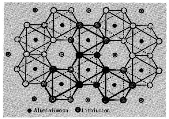
Fig. 2 Schéma d'une couche d'octaèdres [Al,Li(OH)<sub>6</sub>] condensés. Les positions des ions Al<sup>3+</sup> et Li<sup>+</sup> sont ordonnées. Les octaèdres [Li(OH)<sub>6</sub>] peuvent être vides. La couche entière remonte à la composition idéale  $[Al_2Li(OH)_6]^{+2}$ .
