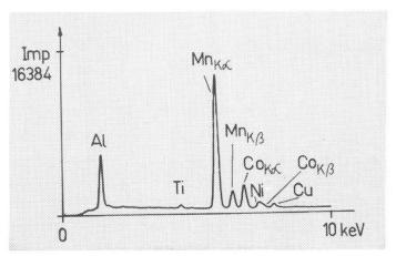
Fig. 7 Spectre de microfluorescence des rayons X d'une lithiophorite synthétisée, avec du Co et Ni. Conditions: 100 kV, 200 sec, transmission, agrandissement 20 000, plaquette analysée au diamètre de 1 μ.
