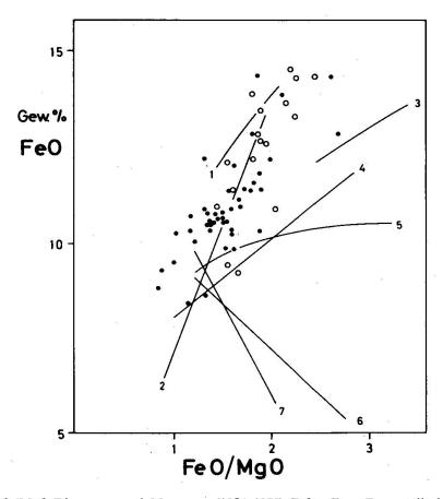
Abb. 11 FeO-FeO/MgO-Diagramm nach MIYASHIRO (1974, 1975). FeO = Fe<sub>tot</sub>. Dargestellt sind auch die Differentiationstrends verschiedener Basaltsuiten. 1 = Skaergaard-Tholeiite. 2 = Basalte des Ozeanbodens (abyssal basalts, mittelozeanische Rücken). 3-7 = verschiedene ozeanische Inselbögen.
