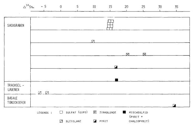
Abb. 3 Schwefelisotopenverteilung in Sulfat und Sulfiden aus den Vererzungen im Sackgraben, Trachsellauenen und Basalen Tonschiefern.
