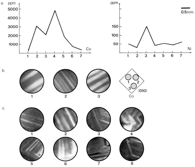
Fig. 5 Verteilung der Co-Gehalte in verschiedenen Pyritkristallen. Dunkel: Niedrige Konzentration. Hell: Höhere Konzentration.
