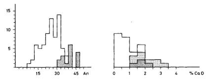
Fig. 3 Vergleich des Anorthitgehalts von Plagioklas mit dem Gehalt an CaO (Gew%) des Muttergesteins. Weiss: CaO-arme Metapelite.
