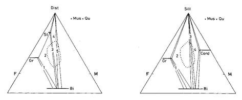
Fig. 8 AFM-Dreiecke mit der Darstellung theoretisch möglicher Mineralparagenesen im Bereich der Staurolithbzw. Sillimanit-Zone. Punktiert: Bereich der analysierten Gesteine aus Fig. 7; die Nummern entsprechen den theoretisch möglichen, im Text genannten Paragenesen.
