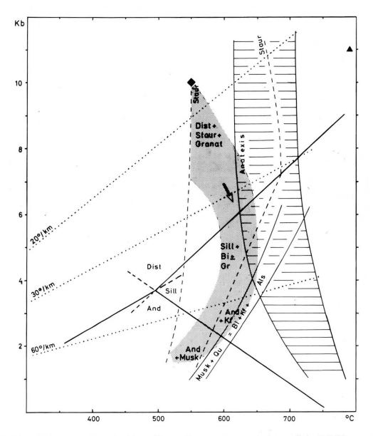
Fig. 12 Die zeitliche Entwicklung der Metapelite von Emosson (gerastert), dargestellt im P-T-Diagramm. Tripelpunkt für Al<sub>2</sub>SiO<sub>5</sub> nach Holdaway (1971); Staur: Stabilitätskurven für Einsetzen (Richardson, 1968) und Instabilwerden (PIGAGE & GREENWOOD, 1982) von Staurolith; Muskowit-Quarz-Reaktion und Bereich der Erstschmelzen nach Thompson, 1982.
