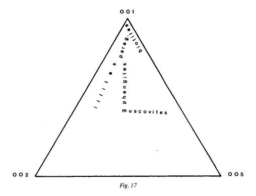
001/002 et 004/005 sont les plus efficaces, car dans le diagramme triangulaire, l'omission du pic (004) entraîne des confusions entre biotites et phlogopites.
