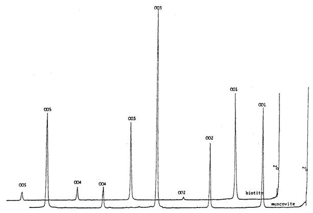
Fig. 1 Diagrammes RX d'une muscovite et d'une biotite.
