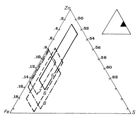
Fig. 5 Diagramme ternaire Fe-Zn-S des domaines de composition des wurtzites.
