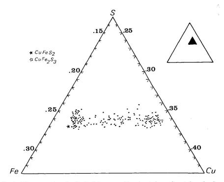
Fig. 6 Diagramme ternaire Cu-Fe-S de composition des chalcopyrites et des cubanites.
