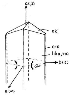
Fig. 1 Habitus d'un monocristal de schuilingite avec les formes principales et la position des éléments optiques.
