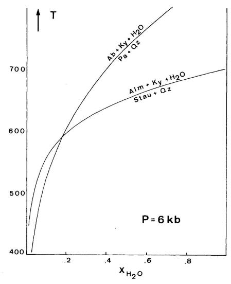
Fig. 8 TX $_{\rm H_{2}O}$  Diagramm bei  $P_{\rm tot}$  = 6 kb. Die beiden gemeinsam auftretenden Gleichgewichtsparagenesen Pa + Qz + Ab + Ky und Stau + Qz + Alm + Ky fixieren das Fluid bei 590 °C und einem  $X_{\rm H_{2}O}$  von 0.17.
