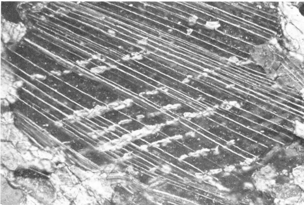
Fig. 3 Dünnschliffaufnahme eines Vintschgauer Marmors (altes Handstück aus der Mineralogischen Sammlung der ETH). Kalkspatkorn mit ähnlichen Gebilden. 180 : 1. Phot. A. Gautschi.
