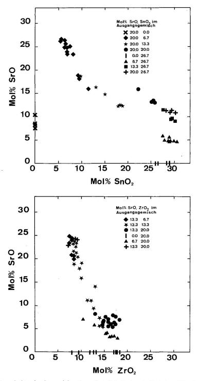
Fig. 2 und 3 Korrelation der Sr- und Sn- (bzw. Zr-) Gehalte in substituiertem Titanit (Mol% SrO, SnO $_2$  bzw. ZrO $_2$  bezogen auf die Titanitformel (CaTiSiO $_5$ ).
