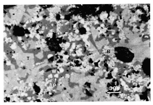
Fig. 1 Anschliff-Foto vom Sinterprodukt mit der Ausgangszusammensetzung 0.6 CaO  $\cdot$  0,4 SrO  $\cdot$  0,4 TiO<sub>2</sub>  $\cdot$  0,6 ZrO<sub>2</sub>  $\cdot$  SiO<sub>2</sub>. T = Titanit, P = Perovskit, W = Wollastonit, B = Baddeleyit.
