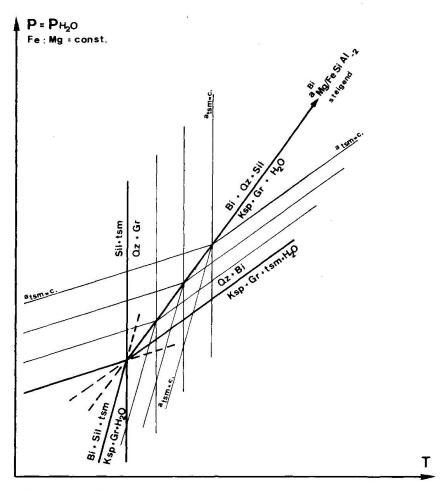
Fig. 15 Reaktionskurvenschar im 5-Komponenten-5-Phasen-System: (SiO<sub>2</sub>-Al<sub>2</sub>O<sub>3</sub>-MgO/FeO-K<sub>2</sub>O-H<sub>2</sub>O) [Sil-Bi-Gr-Qz-Ksp-H<sub>2</sub>O] mit Berücksichtigung der Tschermaksubstitution [Mg/FeSiAl-2] in Biotit.
