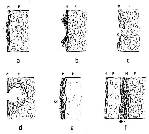
Fig. 1 Typische Formen der Salzverwitterung an Wandmalereien. HMK = Hydromagnesitkruste, M = Malschicht, P = Putzmörtel, S = Salze, SK = Salzkruste.
