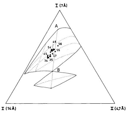
Fig. 3 Diagramme triangulaire donnant l'évolution de la composition chimique des chlorites dans l'auréole de contact M2 (méthode de OĭNUMA et al., 1972).
