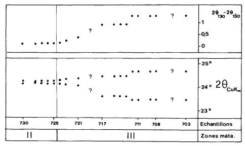
Fig. 2 Migration des réflexions 130 et 130 des plagioclases dans les zones II et III de l'auréole de contact M2.
