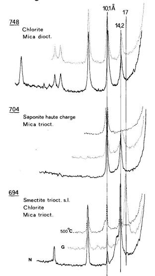
Fig. 8 Diagrammes de diffraction X de fractions argileuses plus petites que 2 microns des échantillons 748, 704 et 694 de l'auréole de contact M2.
