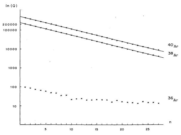
Figure 5 Diagramme (log<sub>e</sub> Q - n) pour l'analyse KA-3-133.
