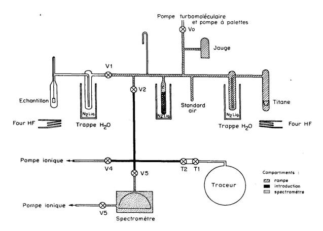
Figure 1 Schéma de la ligne d'extraction.
