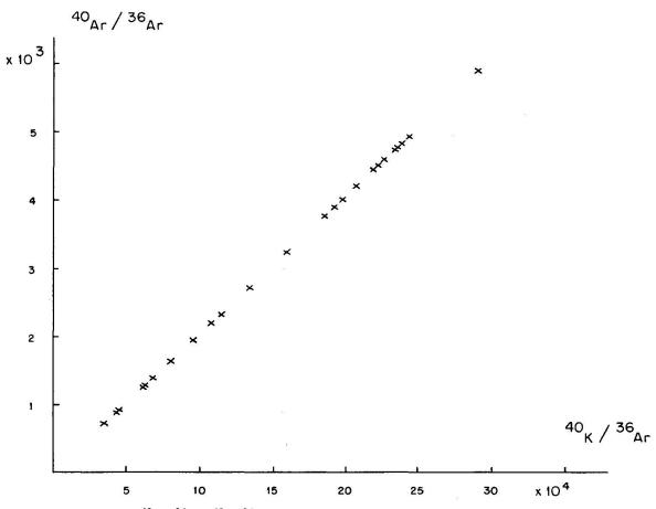
Figure 4 Diagramme (40Ar/36Ar - 40K/36Ar) pour les divers soutirages de l'analyse KA-3-133.
