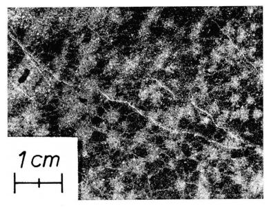
Abbildung 2 Laumontit-Flecken der Probe Arâches 3.
