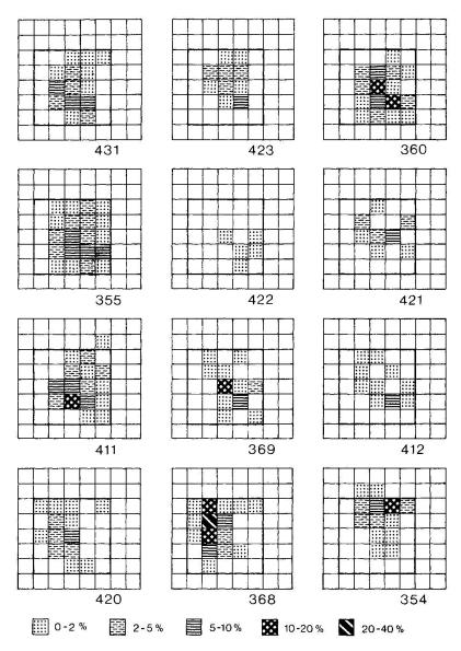
Fig. 3 Distribution typologique des populations de zircons des grès de Thiviers (431-423), ardoise d'Allassac (360), schistes sériciteux de Juillac et Saillant (355-422), quartzo-micaschistes (421-411-369-412), gneiss (420-368-354).
