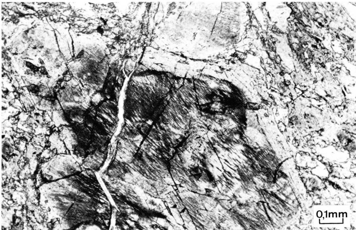
Fig. 4b: Zersetzter Amphibolkern mit Entmischungen einer Ti-reichen Phase (dunkel). Pargastitischer Anwachsrand. // Nic.. (V. Ventina, P2).
