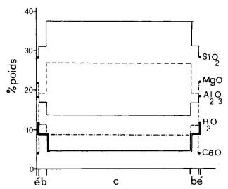
Fig. 2: Variation des principaux oxydes entre les différentes zones d'un filon de rodingite. Ech.  $n^{\circ}$  774.  $\acute{e}$  = éponte, b = bord, c = centre.
