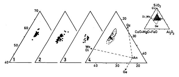
Fig. 5. Konzentrations-Dreieck  $SiO_2$ -CaO+MgO+FeO-Al<sub>2</sub>O<sub>3</sub>. An = Anorthit, Di = Diopsid, Ge = Gehlenit, Wo = Wollastonit, Qz = Quarz.
