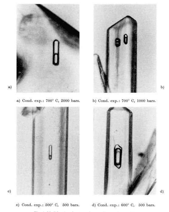
Fig. 6. Modification des taux de remplissage des cavités. Grand.: a, b, c, d)  $\times 1000$ .
