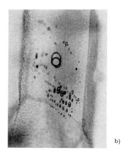
b) La mise au point du microscope met en évidence des cavités coplanaires. Cond. exp.: T  $600^{\circ}$  C, P 1000 bars. Grand.:  $\times 1000$ .
