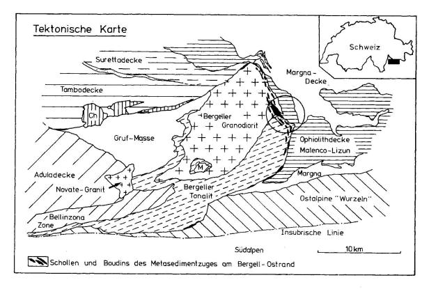
Fig. 1. Tektonische Karte (z. T. nach H. R. Wenk, 1973). M = Fenster von Masino, Ch = Ophiolithe von Chiavenna. Im Kreis: Geologische Kartenskizze Fig. 4.
