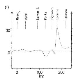
Fig. 2. Anomalies de la déclinaison sur le profil Bâle-Chiasso, obtenu de la fig.1 par la soustraction  $D-2^{\circ}$  53.0′+0.1768 (min./km)d, où d représente la distance en km calculée depuis Bâle (x = 267.663, y = 611.275).
