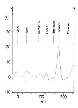
Fig. 4. Anomalies de l'inclinaison sur le profil Bâle-Chiasso, obtenu de la fig. 3 par la soustraction  $I-63^{\circ}12.8'+0.4074$  (min./km)d, où d représente la distance en km calculée depuis Bâle ( $x=267.663,\ y=611.275$ ).
