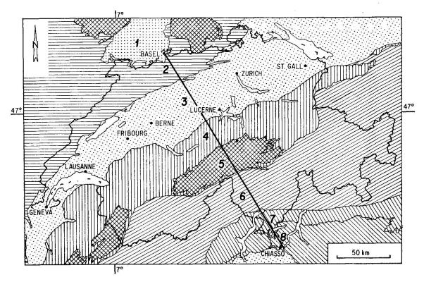
Fig. 1. Die Lage der Schweizer Geotraverse und die durchquerten geologisch-tektonischen Einheiten: (1) Rheingraben, (2) Tafel- und Ketten-Jura, (3) Molasse-Becken, (4) Helvetische Decken, (5) Zentralmassive mit Autochton, (6) Penninikum, (7) Kristallin der Südalpen, (8) Südalpine Sedimente.
