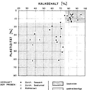
Abb. 5. Vorschlag zur Klassifikation von Seekreide und seekreideartigen Ablagerungen nach Kalkgehalt und Plastizität: Seekreide:  $CaCO_3 > 75\%$ , Ip < 15%; seekreideartige Ablagerung:  $CaCO_3 < 75\%$ , Ip > 15%.
