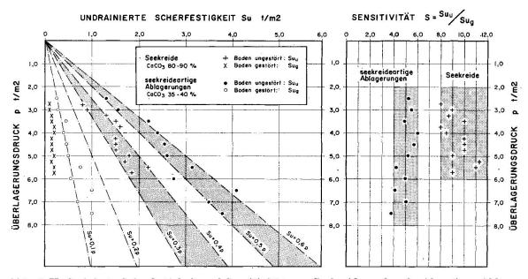
Abb. 6. Undrainierte Scherfestigkeit und Sensitivität von Seekreide und seekreideartigen Ablagerungen in Abhängigkeit des natürlichen Überlagerungsdrucks. Die seekreideartigen Ablagerungen zeigen eine höhere Bruchfestigkeit und geringere Strukturempfindlichkeit als Seekreide.
