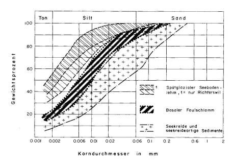
Abb. 2. Summationskurven der Kornverteilung: Charakteristischer Streubereich von Seebodenlehm, basalem Faulschlamm sowie Seekreide und seekreideartigen Sedimenten.
