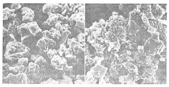
Abb. 10c. Fraktion 63–20  $\mu$  von Seekreide (Probe 1) nach Beschallung (6 Min. Stufe 9). Rasterelektronenmikroskop, 630fach, die Bildbreite entspricht ca. 0,1 mm.
