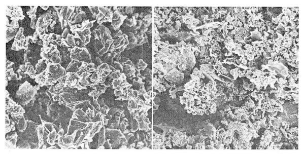
Abb. 10a. Bruchfläche ungestörter, luftgetrockneter Seekreide (Probe 1). Rasterelektronenmikroskop, 1300fach, die Bildbreite entspricht ca. 0,048 mm.
