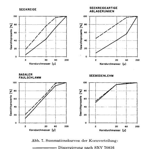
Bei Seekreide und seekreideartigen Ablagerungen bewirkt die Beschallung eine beträchtliche Erhöhung des Feinkornanteils. Beim basalen Faulschlamm und Seebodenlehm erweisen sich dagegen die nach der SNV-Norm bestimmten Kornverteilungen gegenüber der Zufuhr erhöhter Dispergierungsenergie als stabil.
