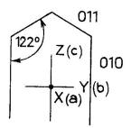
Abb. 6. Joliotitkristall. Schnitt // (100) mit optischer Orientierung.
