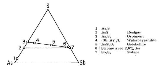
Fig. 2. Diagramme As-Ab-S avec représentation des principales phases ternaires naturelles.
