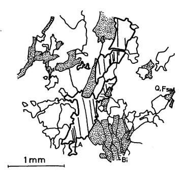
Fig. 3. Bia 517,17. Mit Bi und Mu in s eingeregelte Anhydritkörner (gute Spaltbarkeit, starkes Relief).
