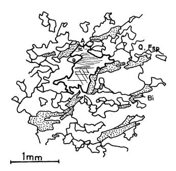
Fig. 2. Bia 629,80. Rekristallisiertes Q-Korn (Q) verursacht plastische Deformation (verbogene Zwillingslamellen).
