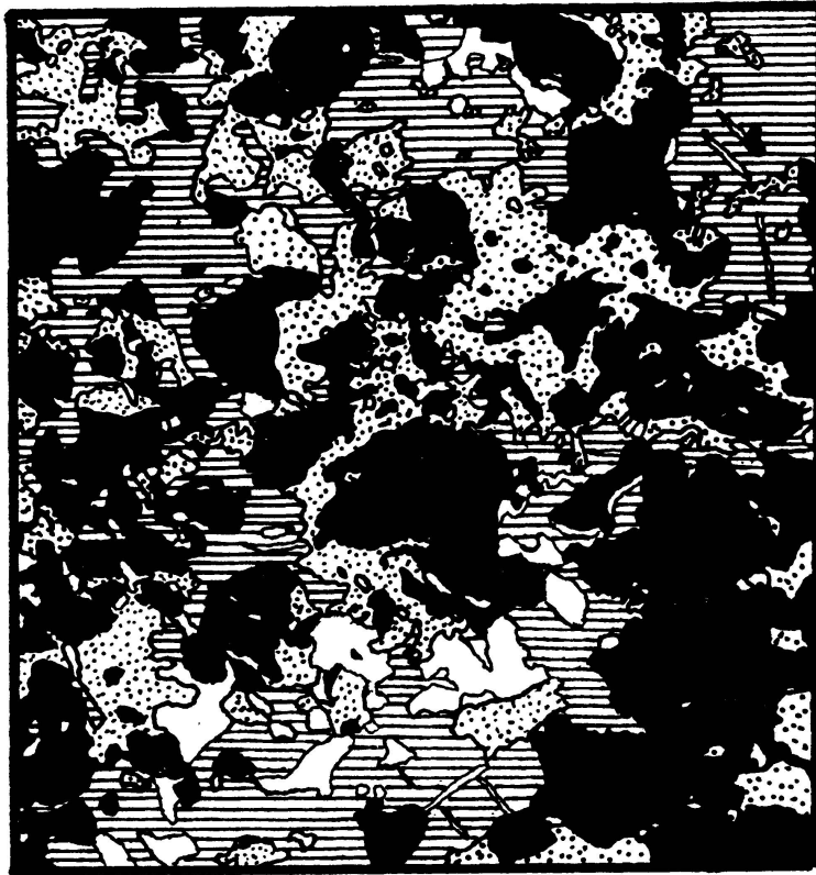
Fig. 2. Zeichnung nach Anschliffphotographie. Alpin umkristallisiertes Pb-Zn-Cu-Erz am Bristenstock (Vorkommen Knappere). Sehr innige, feinkörnige Verwachsung von Bleiglanz (weiss), Kupferkies (horizontal schraffiert), Zinkblende (punktiert) und Gangart (schwarz). Ausschnitt aus Fig. 14 in JENNI, 1973.
