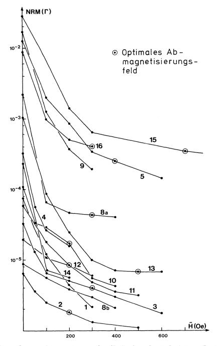
Fig. 2. Mittlere Abmagnetisierungskurven für die Proben der Lokalitäten Nr. 1 bis Nr. 16.
