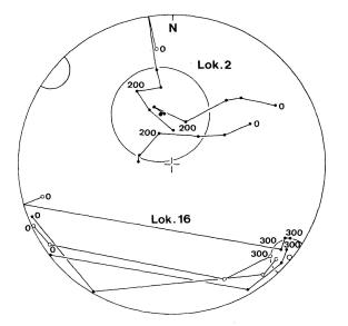
Fig. 3. Richtungsänderung der NRM von 3 Einzelproben der Lokalität Nr. 2 und von 4 Einzelproben der Lokalität Nr. 16 bei fortschreitender Abmagnetisierung.
