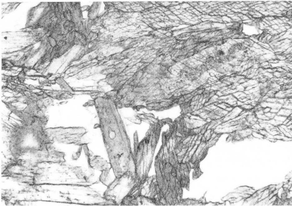
Fig. 24. Zonare Hornblenden in einem Prasinit ( D_{41} ). Man beachte den kontinuierlichen Übergang von farblosem Kern zum pleochroitischen Rand im Korn links. Vergr.: \sim 43\times .
