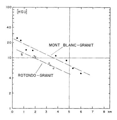
Fig. 2. Exponentielle Abnahme der Wärmeproduktion mit zunehmender Entfernung vom Kontakt Granitkörper/Nebengestein. Logarithmisches Dekrement H in beiden Fällen rund 4 km. Daten aus Rybach et al. (1962), (1966).
