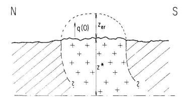
Fig. 3. Schematisches Querprofil durch den Rotondo-Granit. q(0) = Wärmefluss an der Oberfläche. Für  $z^*$  wurde 9,6 km, für  $z_{\rm er}$  3,8 km errechnet (siehe Text).
