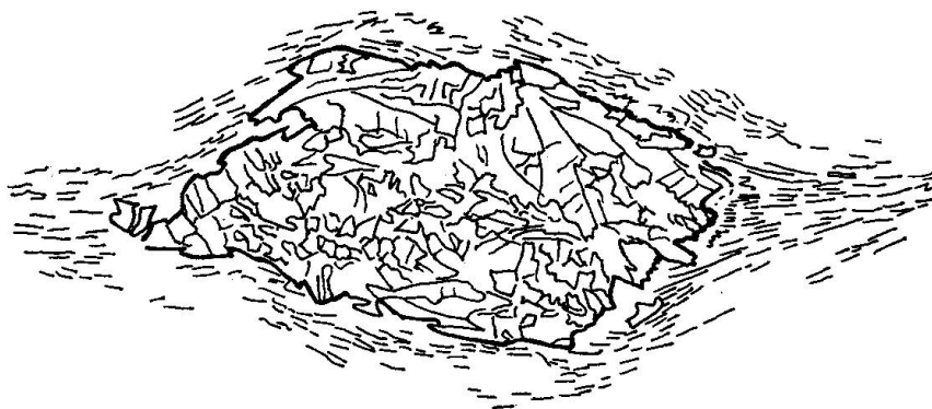
Fig. 8. Lawsonitpseudomorphose, leicht deformiert, besteht aus Zoisit, wenig Epidot und Chlorit in geregelter Grundmasse von Diablastik. (PVB 1127) Vergr. 10 × .
