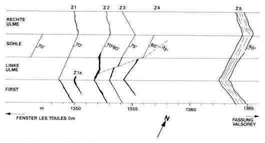
Fig. 2. Profil der mineralisierten Zonen 1-5 zwischen Meter 1348 und 1365. Aus Leu (1960).
