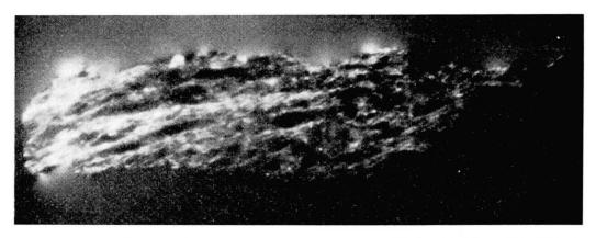
Fig. 5. Radiographie einer stark geschieferten mineralisierten Probe. Reich an Pechblende sind die dünnen Sericit-Graphit-Lagen. Reine gröberkristalline Quarzaggregate sind erzfrei.
