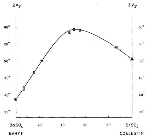
Fig. 3. Abhängigkeit des optischen Achsenwinkels 2  $V_{\gamma}$ , gemessen mit  $Na_D$ -Licht, von der Zusammensetzung der Mischkristalle (in Mol-%  $SrSO_4$ ).
