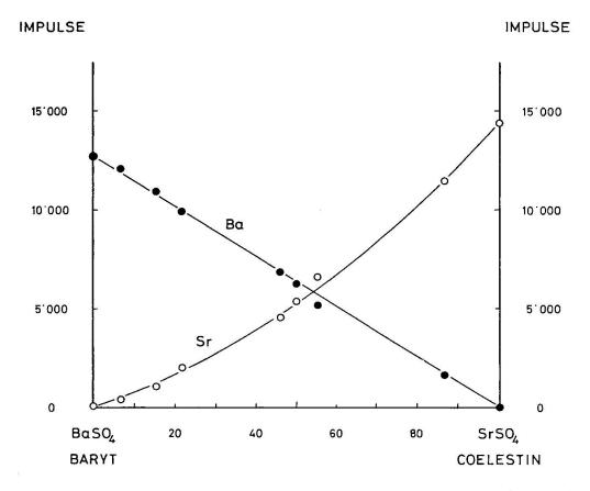
Fig. 6. Bestimmung des molekularen Verhältnisses BaSO<sub>4</sub>/SrSO<sub>4</sub> der Mischkristalle mit Hilfe der Röntgenmikrosonde. Die Impulsraten für Ba bzw. Sr der untersuchten Kristalle sind gegen die Konzentration der Lösung (in Mol-% SrSO<sub>4</sub>) aufgetragen, aus der die Kristalle gezüchtet wurden.
