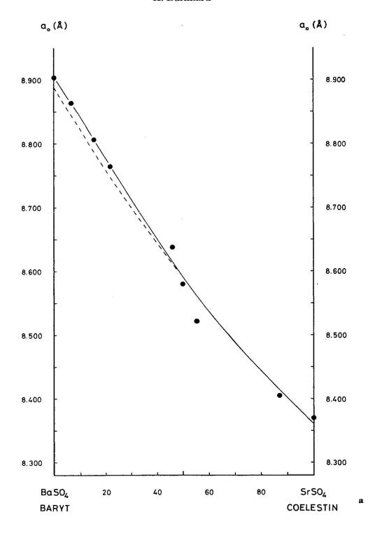
Fig. 4a bis 4c. Zusammenhang zwischen den Gitterkonstanten  $a_0$ ,  $b_0$ ,  $c_0$  und der chemischen Zusammensetzung der Mischkristalle (in Mol-%  $SrSO_4$ ). Die gestrichelt eingezeichneten Kurven stellen die von Boström, Frazer und Blankenburg (1967) veröffentlichten Werte dar.
