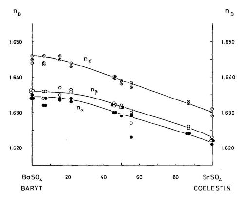
Fig. 2. Abhängigkeit der Brechungsindizes  $n_{\alpha}$ ,  $n_{\beta}$  und  $n_{\gamma}$ , gemessen mit Na<sub>D</sub>-Licht, von der Zusammensetzung der Mischkristalle (in Mol-% SrSO<sub>4</sub>).
