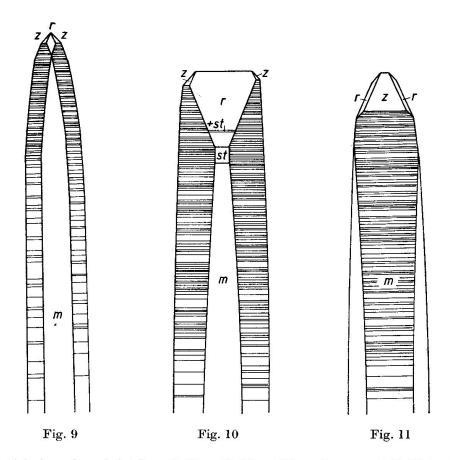
Fig. 9. Beispiel eines Quarzkristalls mit Muzo-Habitus. Die unteren zwei Drittel mit lockerer Streifung erfahren nur eine geringe Verjüngung. Oben wird die Streifung auf den «negativen» Prismenflächen dichter, so dass die Neigung sich zunehmend verstärkt. Dadurch verengt sich die zwischen ihnen befindliche «positive» Prismenseite immer mehr und verschwindet am Ansatz des Grundrhomboeders. (Taminser Calanda, 50 mm.)
