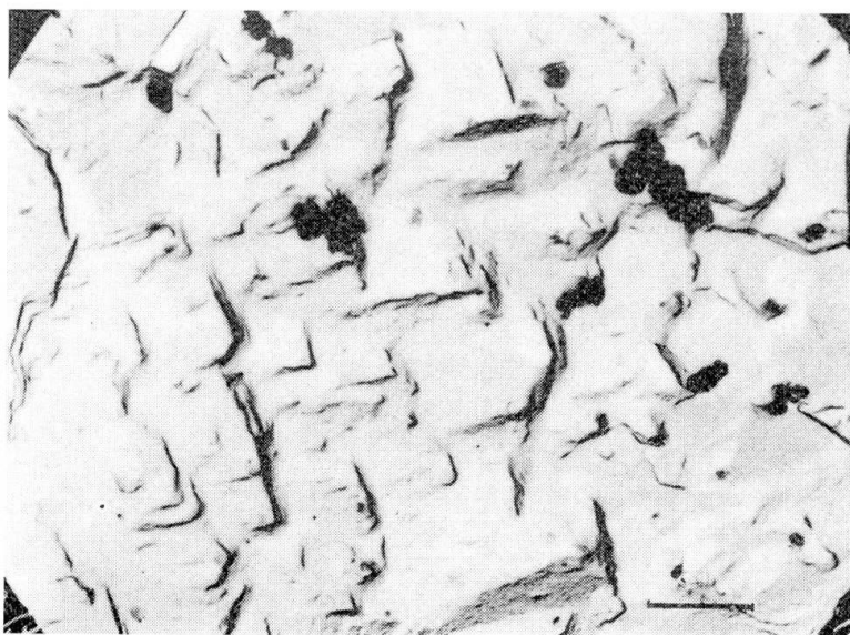
Fig. 5. Ätzfiguren: Oktaeder auf tafeliger Goldblech-Unterlage an Gotthardgold. Aufnahme: Siemens ELMISKOP-I. Skala = 1 Mikron.
