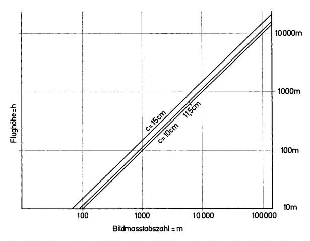
Fig. 5. Beziehung zwischen Flughöhe (h) und Bildmassstabszahl (m) für Objektive (Typus Aviogon) mit verschiedenen Brennweiten (c).
