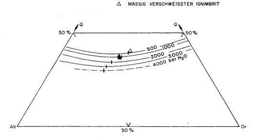
Fig. 6. Quarz/Na-Feldspat/K-Feldspat-Schmelzdiagramm nach Tuttle und Bowen (1958). Eingetragen ist die Grundmasse einiger Gesteine der Tuff-Ignimbritserie. Der geringe Anorthitgehalt kann hier unberücksichtigt bleiben.
