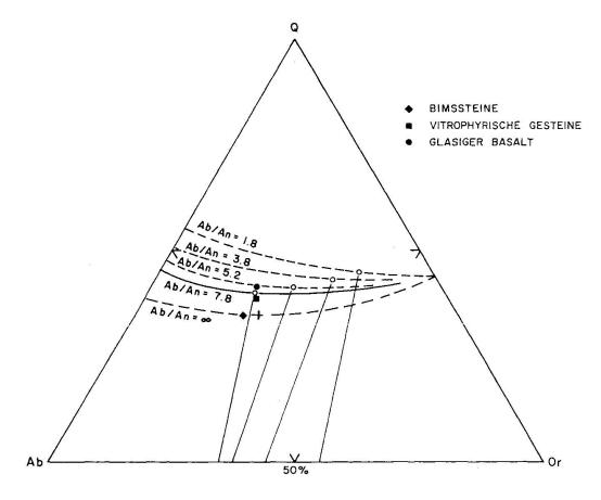
Fig. 7. Quarz/Na-Feldspat/K-Feldspat-Schmelzdiagramm nach Platen (1965) für 2000 bar H<sub>2</sub>O-Druck mit Berücksichtigung des Anorthitgehaltes. Eingetragen ist die Grundmasse einiger Gesteine der Rhyolith-Vitrophyrserie.
