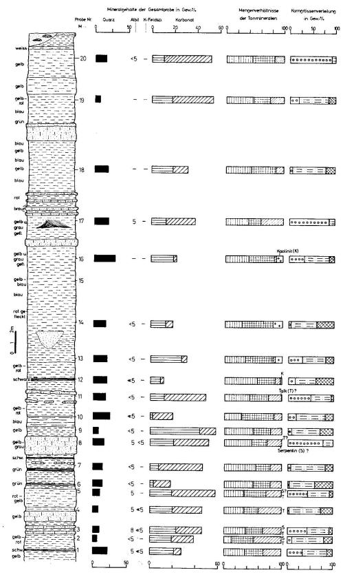
Fig. 2. Schematisches Profil und Zusammensetzung der untersuchten tortonen Molassegesteine der Grube Mettlen (TG). Legende zum Profil siehe Fig. 1.
