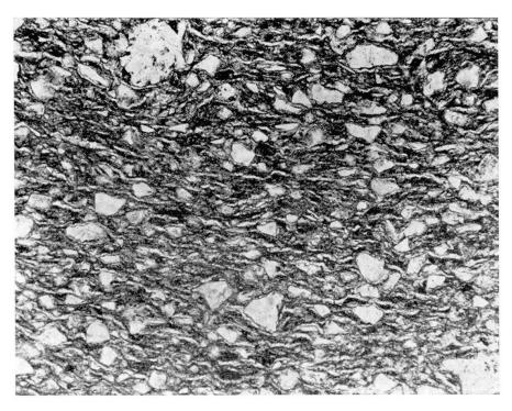
Fig. 6. Dünnschliffbild eines Ziegelscherbens mit stark anisotroper Textur, verursacht durch parallelorientierte Längsporen (im Bild die feinen weissen, welligen Gebilde); Vergr.  $175 \times .$
