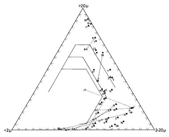
Fig. 4. Winkler-Diagramm mit den untersuchten Gesteinsproben von Rafz (Kreise) und Mettlen (Dreiecke). Ausgefüllte Kreise, bzw. Dreiecke stellen die nicht vorbehandelten, leere Kreise und Dreiecke die vorbehandelten Proben dar.
