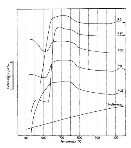
Fig. 7. Einige typische Dilatometerkurven von Proben aus der Grube Rafz.
