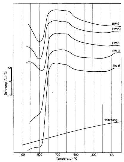
Fig. 9. Einige typische Dilatometerkurven von Proben aus der Grube Bruggwald.
