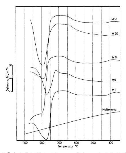
Fig. 8. Einige typische Dilatometerkurven von Proben aus der Grube Mettlen.
