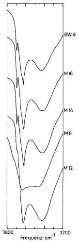
Fig. 5. Ultrarotspektren im Bereiche des OH-Bandes (3700 cm<sup>-1</sup>) von kaolinitführenden Gesteinsproben aus den Gruben von Mettlen und Bruggwald (Backsteinmischung). Zum Vergleich ist auch eine Probe ohne Kaolinit (M 6) aufgeführt.
