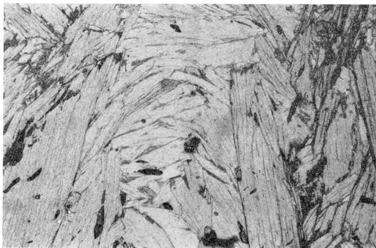
Fig. 16. Gefüge Q_5 . Helliglimmerschiefer. Polygonalfalten von Helliglimmer. Die Helliglimmer zeichnen mimetisch eine ältere Feinfältelung nach; sie sind völlig rekristallisiert und nachher nur noch schwach verbogen worden. Die dunkleren Partien um die Helliglimmer herum und in den Zwickeln bestehen aus braunem Biotit. Vergr. \sim 11\times .
