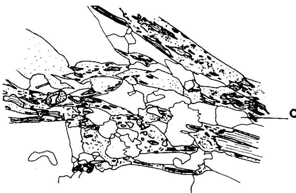
Fig. 28. Hellglimmer und Biotit werden von Albit (punktiert) korrodiert und aufgezehrt (Gneis S_{60} ). Vergr. 24\times .
