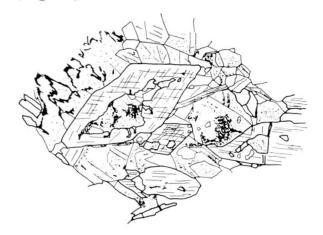
Fig. 24. Bildung von Aktinolith in Dolomit ( $S_{37}$ ) (punktiert), Quarz ( $\pm$ rundlich, ohne Signatur); der dabei neugebildete Kalzit ist polygonal und wasserklar (zum Beispiel im Kern des grössten Hornblendekorns). Schwarz: Erzausscheidungen im Dolomit. Vergr.  $\sim 19 \times$ .
