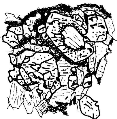
Fig. 25. Hellglimmer in einem Eklogit ( T_{16} ); punktiert: Omphazit; dunkles Gewebe: Diablastik. Der grösste Granat umschliesst ein Hellglimmerpaket. Vergr. 24\times .
