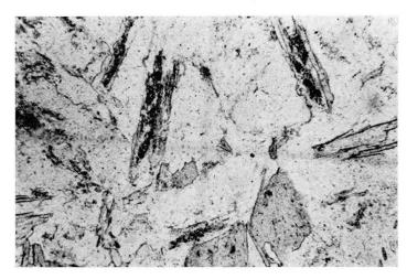
Fig. 23. Pseudomorphosen nach aktinolithischer Hornblende in einem Gneis  $(X_{10})$ . Unten: Chlorit ( $\pm$ Erz) pseudomorph nach Hornblende; oben: Chlorit+Albit+Hellglimmer  $\pm$ Erz pseudomorph nach Hornblende. Vergr.  $42\times$ .
