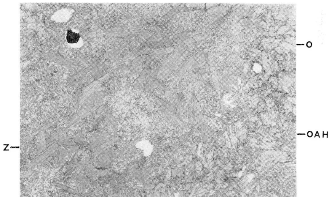
Fig. 5. Gefüge F 74b . Omphazitfels mit hornblendeführender Partie. Hornblende und Omphazit sind mechanisch beansprucht. Der Omphazit grenzt ohne Zwischenschicht von Diablastik direkt an Albit. Die helleren Flecken in der Hornblende sind Omphazitrelikte. Vergr. \sim 9\times .
