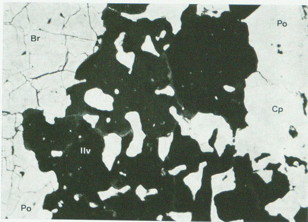
Fig. 6. Ilvait-Sulfid-Gefüge (Vorkommen Cotschens, Westufer Marmoreraasee). Einzelne lappig-unregelmässige Ilvaite (Ilv) werden von Sulfiden (Pyrrhotin Po, Chalkopyrit Cp und Bravoit Br) verdrängt. Vergr. 350 × ohne gekreuzte Nicols in Öl.
