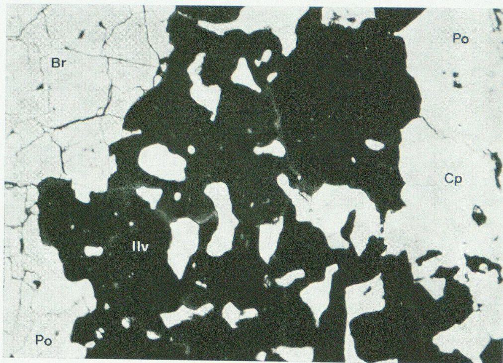
Fig. 6. Ilvait-Sulfid-Gefüge (Vorkommen Cotschens, Westufer Marmoreraasee). Einzelne lappig-unregelmässige Ilvaite (Ilv) werden von Sulfiden (Pyrrhotin Po, Chalkopyrit Cp und Bravoit Br) verdrängt. Vergr. 350 \times ohne gekreuzte Nicols in Öl.
