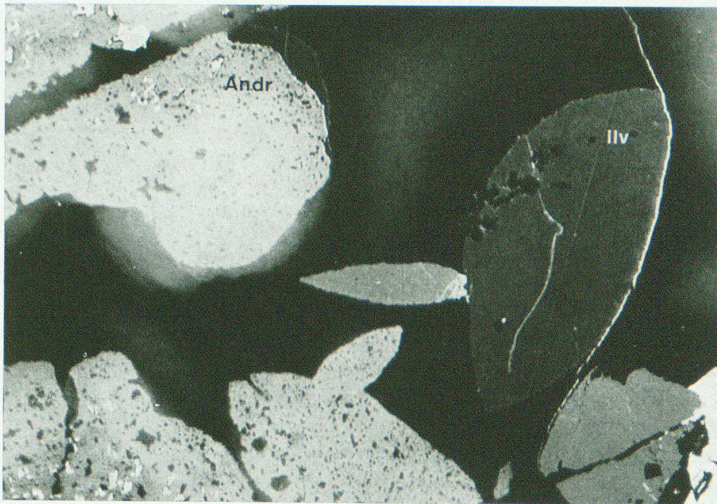
Fig. 5. Ilvait-Kristalle im Erzanschliff (Vorkommen Cotschens). Die Ilvaite zeigen oft abgerundete linsenförmige Querschnitte. Der unterschiedliche Grauton beruht auf dem starken Reflexionspleochroismus (grau // a und b, blau // c). Hellgrau erscheinen Andraditaggregate (mit weissen Innenreflexen), weiss Magnetit und schwarz die serpentinitische Grundmasse. Vergr. 315 × ohne gekreuzte Nicols in Öl.
