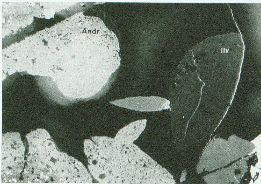
Fig. 5. Ilvait-Kristalle im Erzanschliff (Vorkommen Cotschens). Die Ilvaite zeigen oft abgerundete linsenförmige Querschnitte. Der unterschiedliche Grauton beruht auf dem starken Reflexionspleochroismus (grau // a und b, blau // c). Hellgrau erscheinen Andraditaggregate (mit weissen Innenreflexen), weiss Magnetit und schwarz die serpentinitische Grundmasse. Vergr. 315 \times ohne gekreuzte Nicols in Öl.
