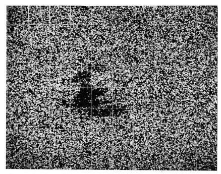
Fig. 4. Même champ et même plage que dans Fig. 3. Balayage pour Sb. On constate, en dehors du "trou" dû à la galène, l'homogénéité de la plage.  $\times$  2000. 1 cm = 5  $\mu$ .
