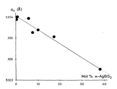
Fig. 1. Abnahme der Gitterkonstanten a<sub>0</sub> bei Bleiglanz bei zunehmendem Gehalt an Schapbachit.
