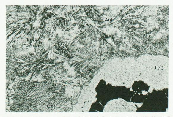
Fig. 3. Grüner Ophicalcit, der von Talk und Antigorit durchsetzt wird. D 1267, Koord. 768.27/151.82 (Westufer Marmorerasee). Rechts unten: Serpentinkomponente (Lizardit/Chrysotil mit Chromspinellrelikt). Vergr. 51× mit gekreuzten Nicols.
